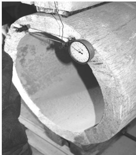
Рис. 2. Измерение деформаций растяжения сталефибробетона
