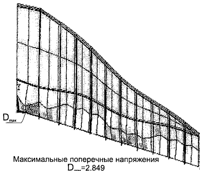
Рис. 3. Картина деформации переборки при действии гидростатического давления
