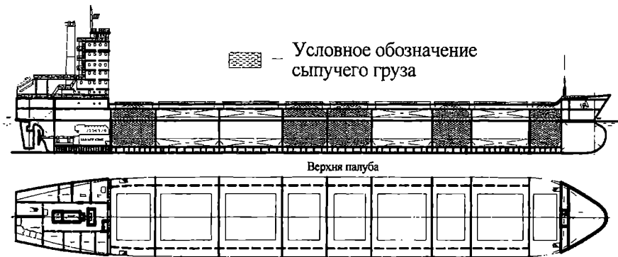
Рис. 2. Схема чередующейся загрузки трюмов
