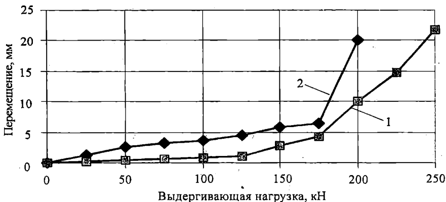
Рис. 4. Графики зависимости «выдергивающая нагрузка на анкер – перемещение анкера»: 1 – статические испытания; 2 – моделирование
