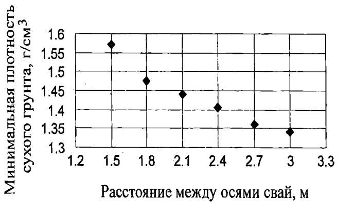
Рис. 3. График изменения минимального значения плотности сухого грунта в массиве в зависимости от расстояния между осями грунтовых свай
