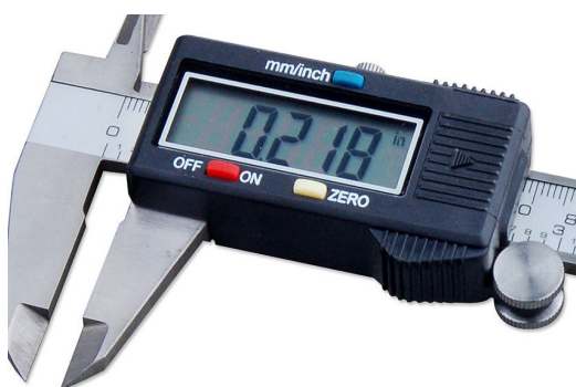
в) – Цифрові електронні (з інкрементною або фотоелектронною шкалою)
