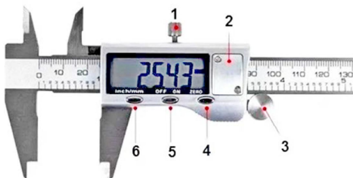
Рис. 2. Будова цифрового штангенциркуля:
