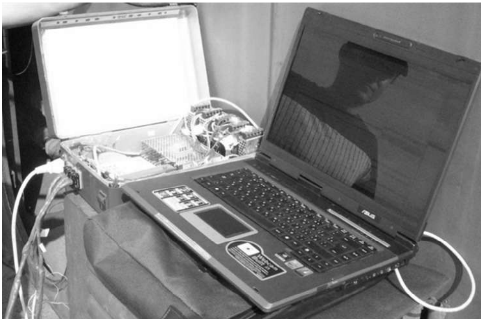
Рис. 8. Тензостанція з 32 інформаційними каналами
