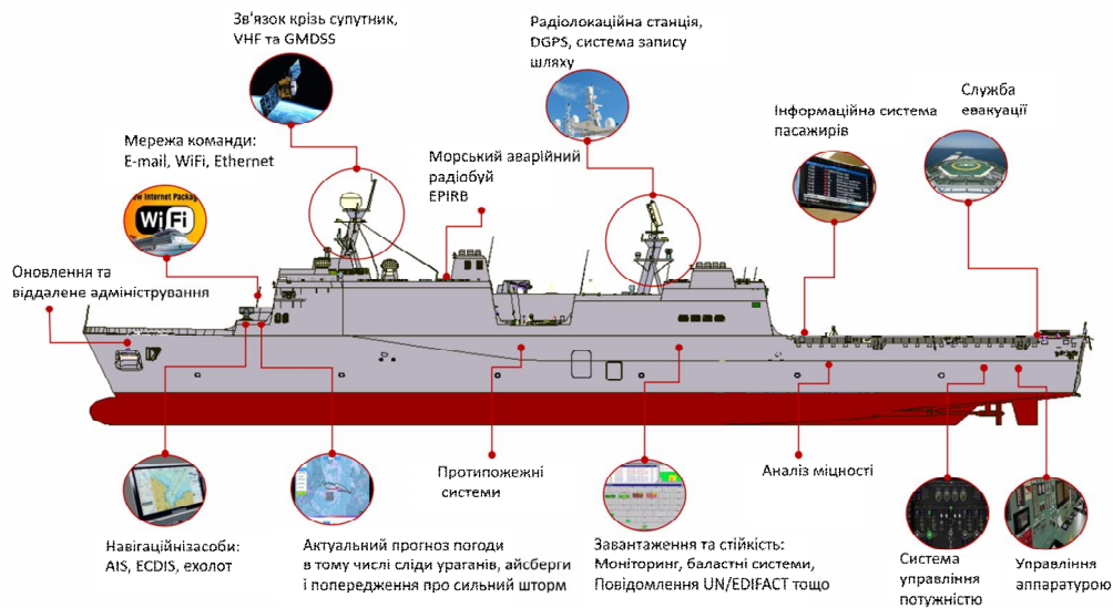
Рис. 1. Приклади важливих автоматичних систем сучасних суден, які можуть бути об'єктами кібератаки
