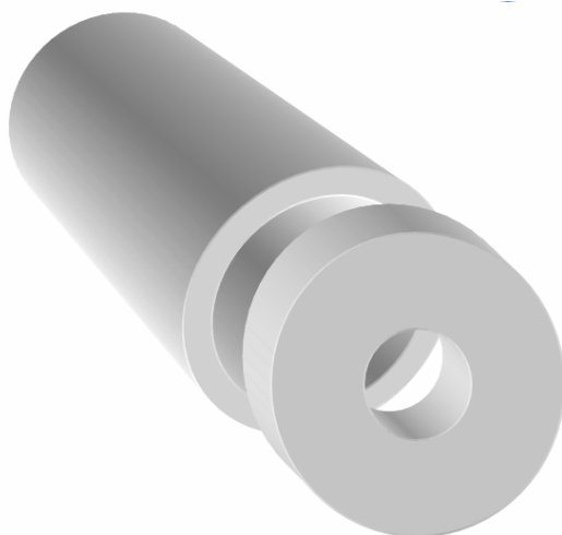
Рис. 1. Гільза з дефектом та вогнетривка заглушка
