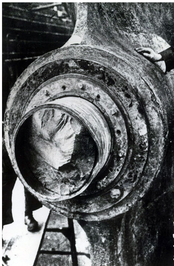
Рис. 1. Разрушение гребного вала с потерей винта
