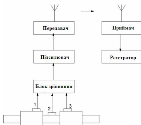
Рис. 2. Структурна схема тензометричного витратоміру [3]
